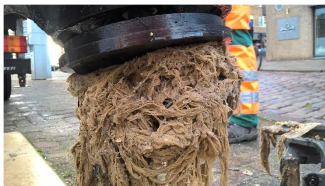
Figuur 1-2: Opgehoopte vezels in een pomp
