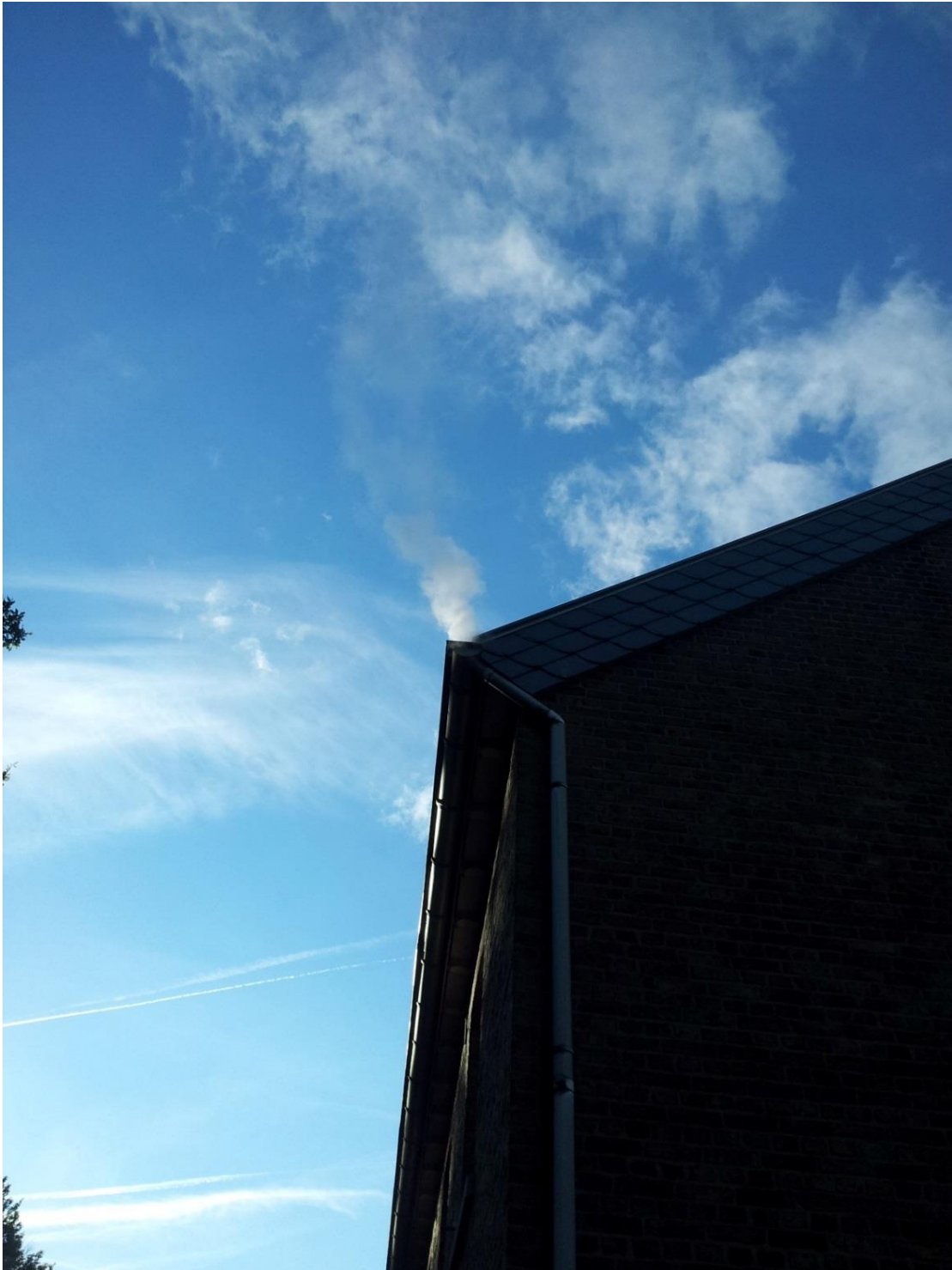
Figuur 6-7: Opsporen van foutaansluitingen met rook
