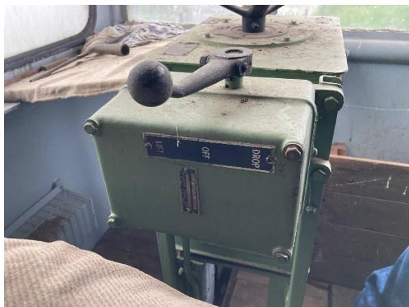
Bedieningskast en gelijkrichter voor de hefmagneet (Foto: Hens ter Kuile)
