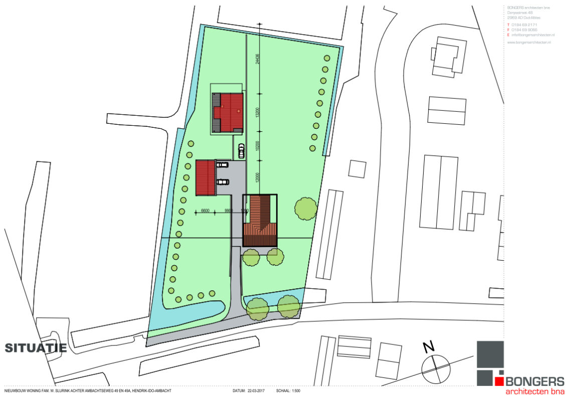
Afbeelding 2 Tekening situatie. geplande nieuwbouw is in rood aangegeven. Bron: Bongers architecten bna.
