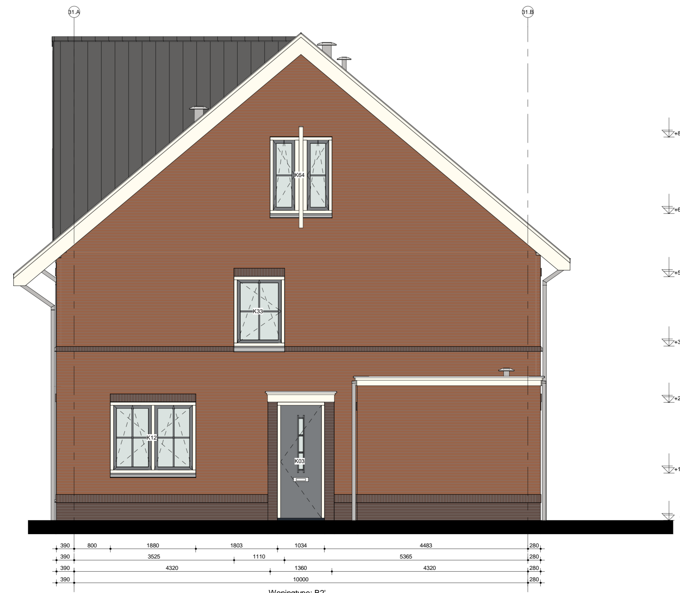
Rechtergevel blok 31 & 33 als getekend blok 32 & 34 als gespiegeld
