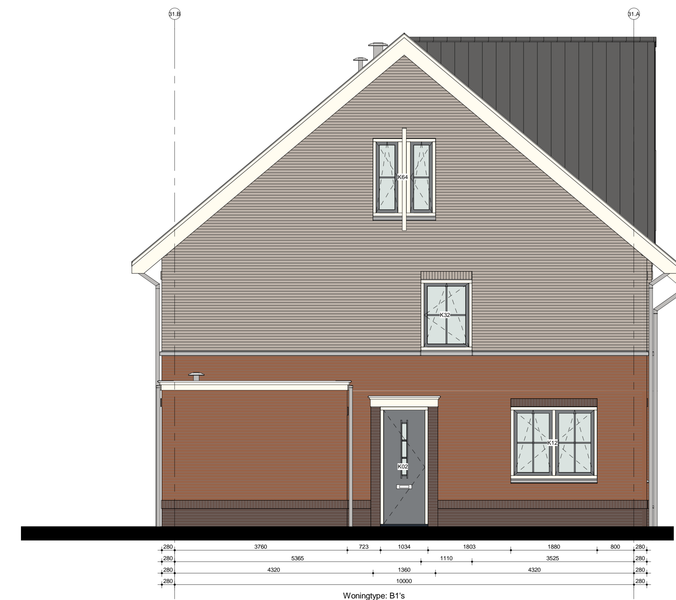
Linkergevel blok 31 & 33 als getekend blok 32 & 34 als gespiegeld
