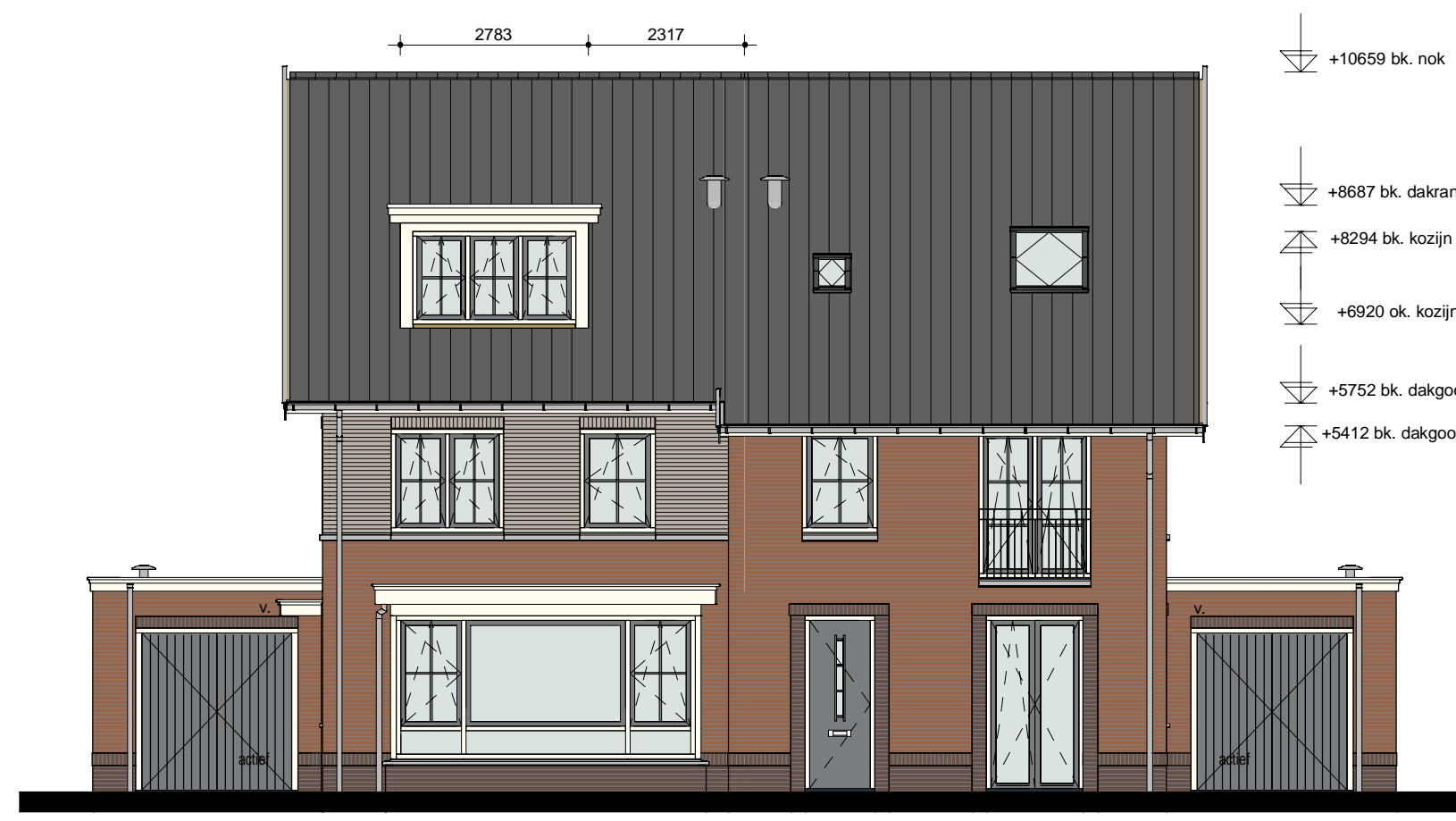
Woningtype B8a Bwrr 85 als get. Bwrr 80 als gesp. - optie erker voorgevel (alleen mogelijk bij woningtype B8) - optie uitbreiding woonkamer 1,2m - optie vergrote berging - optie dakkapel voorgevel Woningtype B9 Bwrr 84 als get. Bwrr 81 als gesp. - optie uitbreiding woonkamer 2,4m - optie kleine dakraam tech. ruimte - optie groot dakraam voorgevel Voorgevel Blok 24 als getekend Blok 22 als gespiegeld
